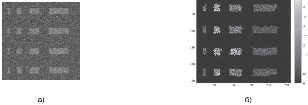
Рисунок 8. Селекция объектов по коэффициенту удлинения главной оси описывающего эллипса: а – исходное изображение; б – выделенные объекты. Яркости объектов обратно пропорциональны соответствующим коэффициентам удлинения главной оси описывающего эллипса Figure 8. Selection of objects by the coefficient of elongation of the main axis of the describing ellipse: а – the original image; б – selected objects. The brightness of objects is inversely proportional to the corresponding elongation coefficients of the main axis of the describing ellipse
