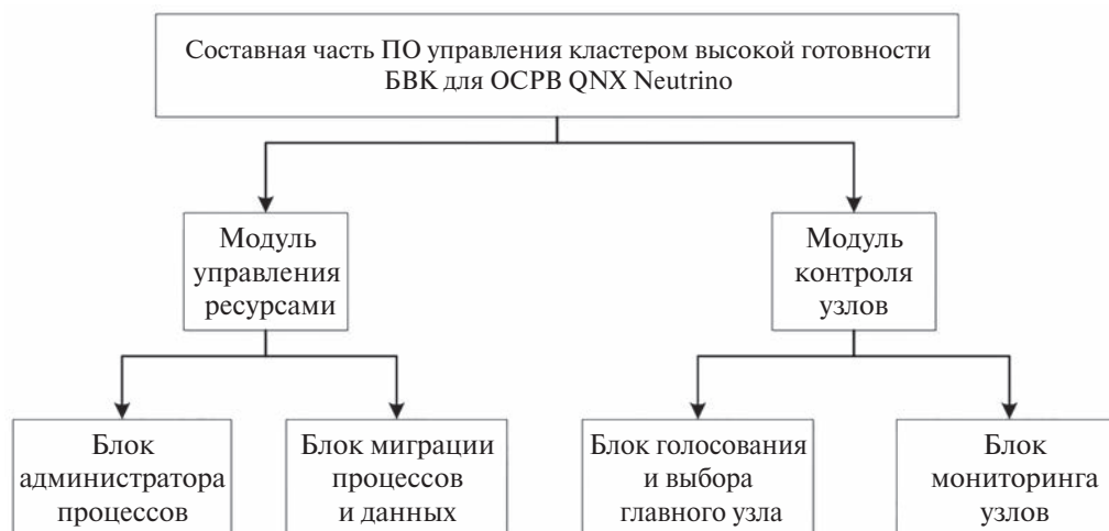
Рисунок 3. Структурная схема составной части ПО управления кластером высокой готовности БВК для ОСПВ QNX Neutrino
