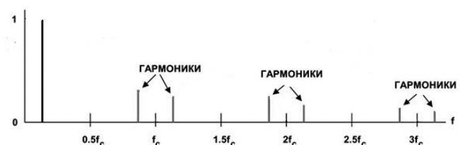
Рисунок. Спектр сигнала на выходе цифро-аналогового преобразователя
