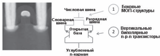
Рисунок 4. Концепция бистабильной одностранзисторной памяти фирмы Zeno Semiconductor
