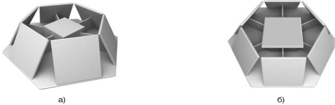
Рисунок 4. Кластерное построение радиолокационной системы: а – коммутатор антенных подрешеток; б – способ покрытия зоны зенита
